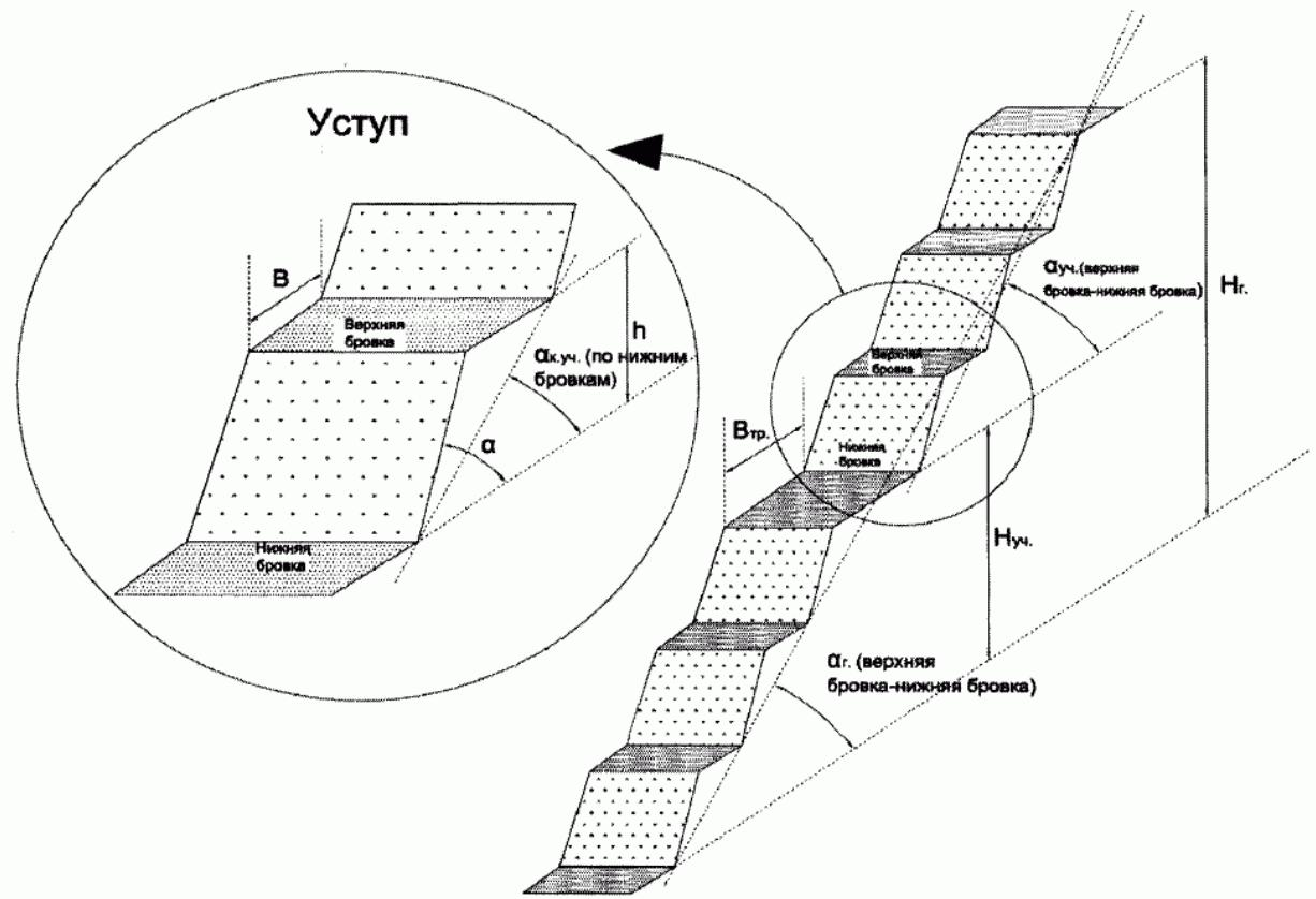
Рисунок 1. Схема конструкции бортов и уступов:  $h$ ,  $H_{\text{уч}}$ ,  $H_r$  - соответственно высота уступа, групп уступов, борта;  $a$ ,  $a_{\text{уч}}$ ,  $a_{k,\text{уч}}$ ,  $a_r$  - соответственно, угол откоса уступа, угол откоса группы уступов, конструктивный угол откоса группы уступов и угол откоса борта карьера, разреза;  $B$ ,  $B_{\text{тр}}$  - соответственно, ширина предохранительной и транспортной бермы
