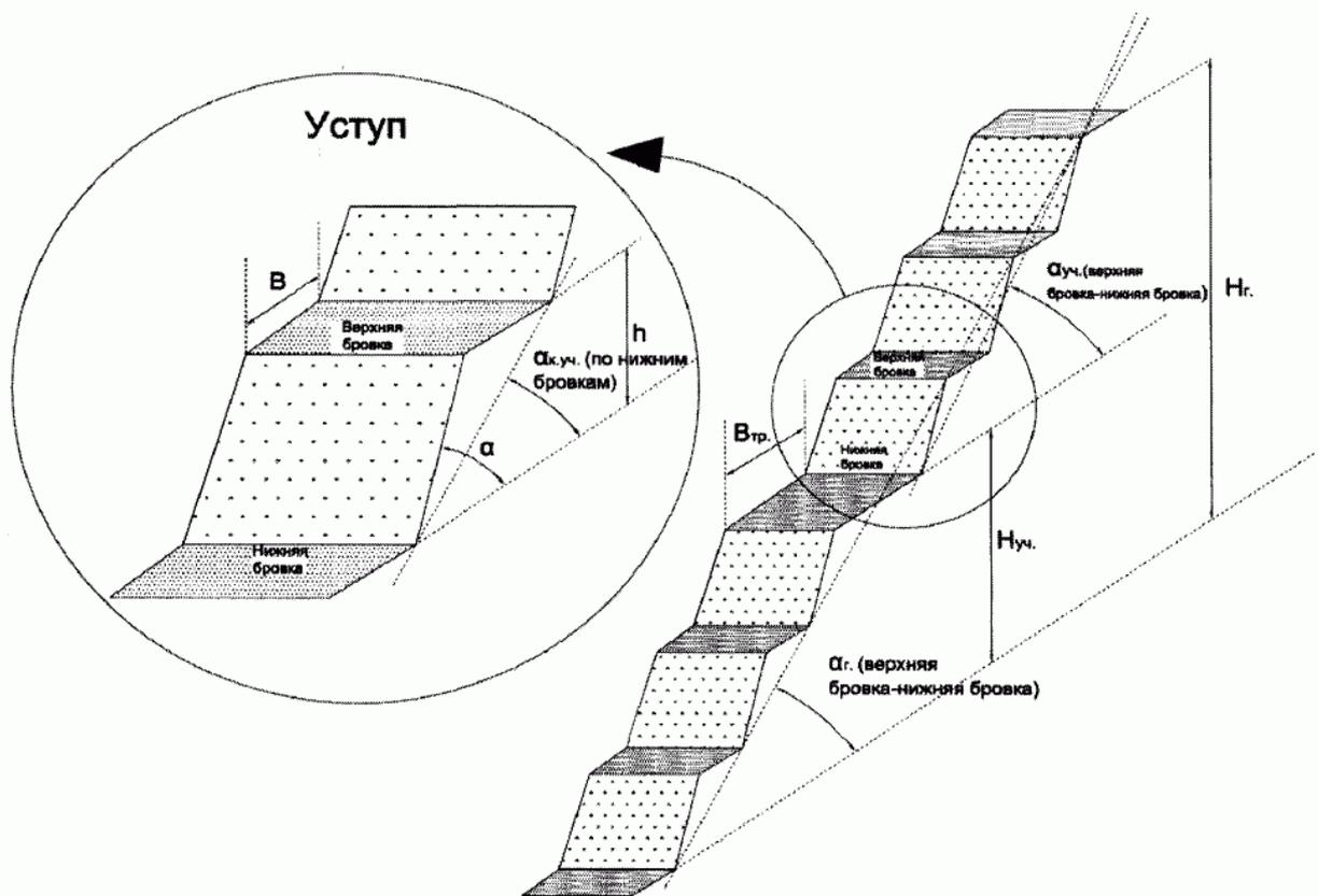
Рисунок 1. Схема конструкции бортов и уступов:  $h$ ,  $H_{г.}$ ,  $H_{уч.}$  - соответственно высота уступа, групп уступов, борта;  $\alpha$ ,  $\alpha_{уч.}$ ,  $\alpha_{к.уч.}$ ,  $\alpha_{г.}$  - соответственно, угол откоса уступа, угол откоса группы уступов, конструктивный угол откоса группы уступов и угол откоса борта карьера, разреза;  $B$ ,  $B_{тр.}$  - соответственно, ширина предохранительной и транспортной бермы
